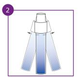
Schließen Sie das Extraktionsgefäß mit dem Verschluss und schütteln Sie es von Hand **1 Minute** lang. Tauschen Sie den Extraktionsverschluss mit dem Tropfaufsatz aus.
