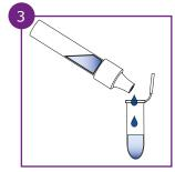
Überführen Sie 12 Tropfen (400 µL) des Überstandes durch Zusammendrücken des Extraktionsgefäßes in das Inkubationsgefäß.
