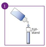
Homogenisieren Sie die Probe und füllen Sie hiervon 0,2 g oder 0,2 ml einer flüssigen Probe oder Spülwasser. (Falls keine Waage ver-fügbar ist, kann mit der Verschlusskappe die nötige Menge abgeschätzt werden). Füllen Sie das Extraktionsgefäß mit dem Extraktionspuffer bis zu der markierten Stelle an (siehe Grafik).
